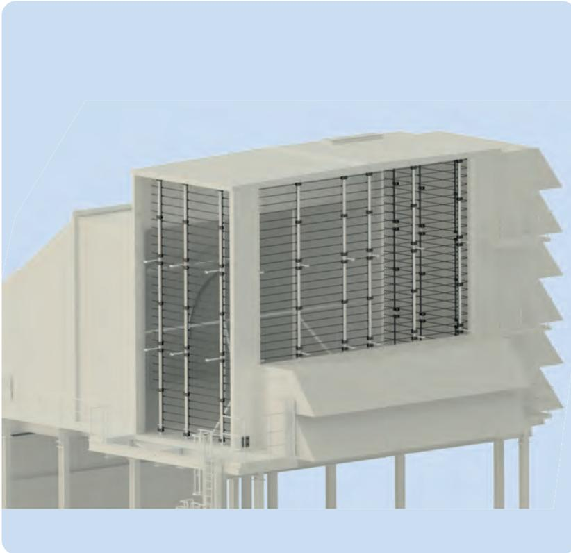
Il sistema **Internal Air Intake** è il **tradizionale fogging**, le rampe di spruzzo sono poste sempre a valle del sistema di filtrazione e questo permette agli ugelli di coprire tutta l'area dell'intake, di operare senza by-pass dell'aria e di lavorare con tutte le condizioni di pressione delle pompe (dal minimo al massimo senza differenze significative di micrometria delle gocce d'acqua).
