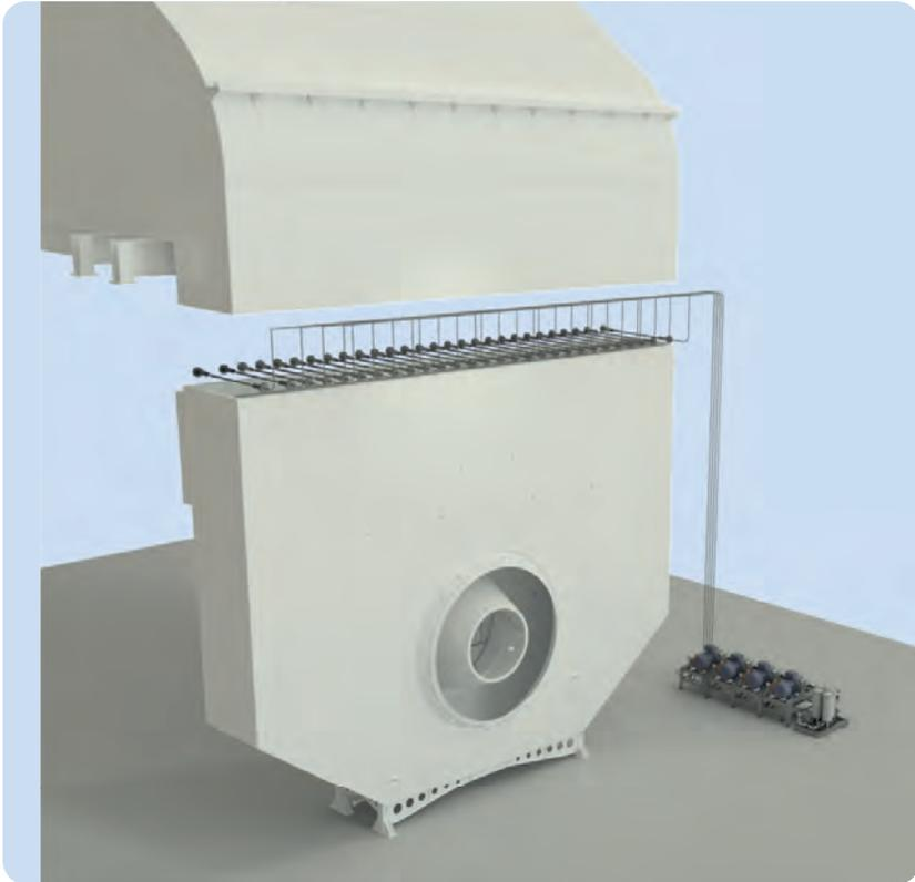
Il sistema **High Fogging** (o *Wet Compression*) viene posto dopo i silenziatori e dove possibile vicino all'ingresso del compressore, **permettendo di ottenere migliori prestazioni delle turbine a gas con un recupero significativo di MW aggiuntivi fino al 6,3-9,6% della potenza nominale.**
