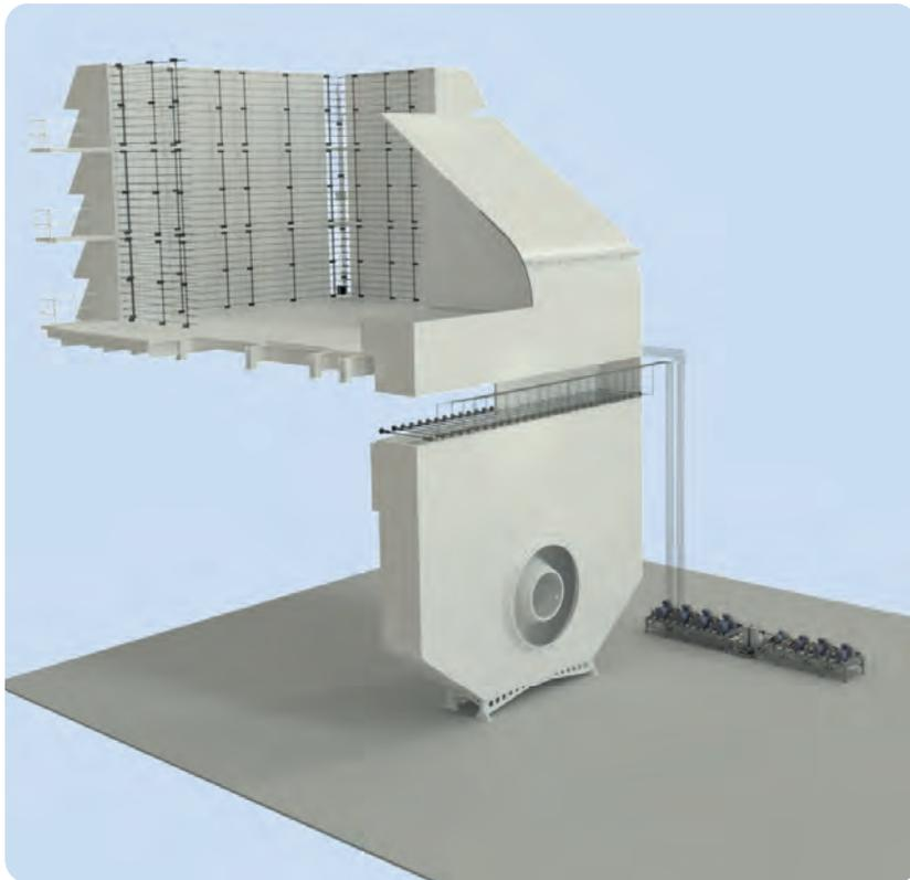
La **nuova tecnologia Double Fogging** prevede la combinazione di un Sistema Fogging all'Interno dell'Air Intake e, dopo la filtrazione, di un High Fogging con l'aggiunta di rampe di ugelli poste dopo i silenziatori, posizionati sulle pareti del condotto.
