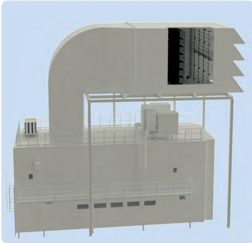
Il sistema **External Fogging** viene installato all'esterno dell'Air Intake a monte dei filtri: questa tipologia di impianto assicura gli stessi vantaggi di quello interno e può essere installato senza interrompere il funzionamento della turbina o solo per qualche giorno. È **particolarmente adatto per essere installato su piccole turbine da 2 MW a 25 MW.**
